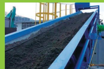
排出ベルコンにより、改良土を搬出いたします。流動材の場合はポンプ排出いたします。
