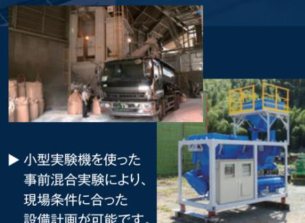
▶ 小型実験機を使った事前混合実験により、現場条件に合った設備計画が可能です。
