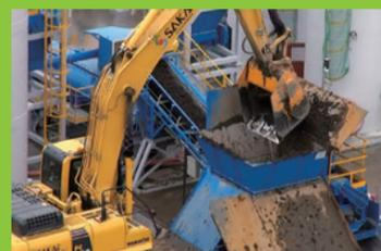
土砂供給機により、土砂を定量切り出します。
