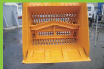
解砕選別装置により、夾雑物の篩分け、土塊の解砕、投入を行います。
