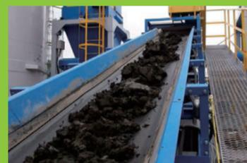
計量ベルコンにより土砂を連続計測します。
